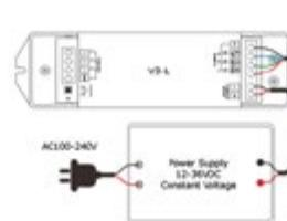
12V DC Max: 216W - 24V DC Max: 432W
