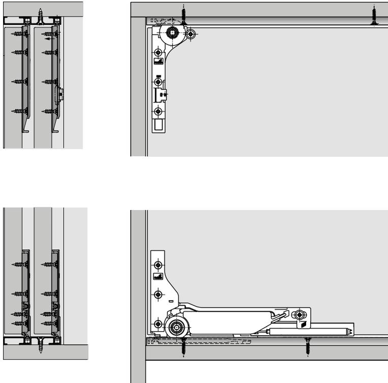
Начин на монтирање/ Профил со 1- канал со жлеб
