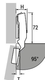
Висина на телото на шарката H/ растојание од страницата при отворање на вратата T за растојание D=0mm и растојание до отворот за шарката C=3mm
