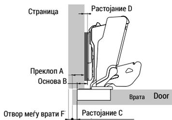
$$\text{Растојание D} = \text{C} + \text{B} - \text{A}$$
