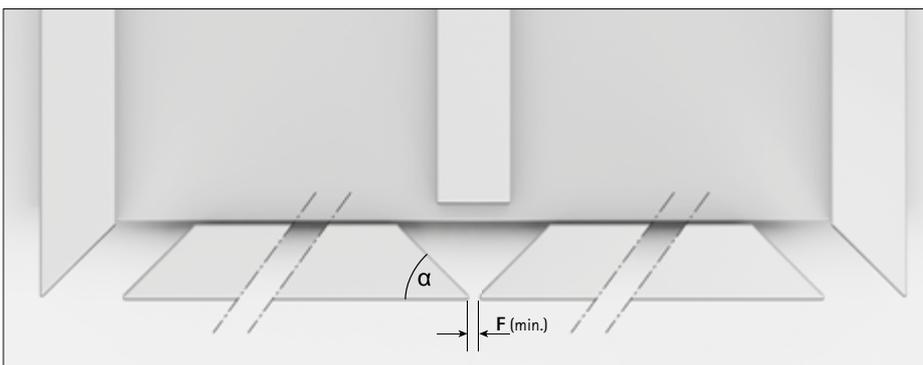
Дизајн без рачки но и без видливи рабови од кантот може да се постигне со сечење на кантовите на страницата од плакарот и фронтот под гер ( $45^\circ$ ). Со тоа добиваме доволен отвор за отворање со прсти од страничниот кант на вратата и тесен Среден меѓупростор.
