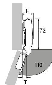
Висина на телото на шарката H/ растојание од страницата при отворање на вратата T за растојание D=0mm и растојание до отворот за шарката C=3mm
