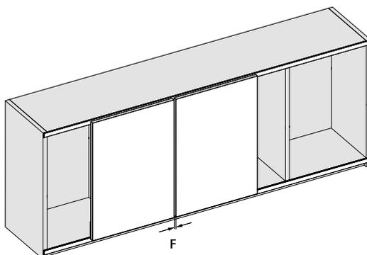
Централното растојание помеѓу две дрвени врати зависи од позициите за бушење  $B_1$  и  $B_2$  за лизгачките и водечките составни елементи. Користење на стандарден шаблон за бушење овозможува централно растојание  $F = 10\text{mm}$ .
