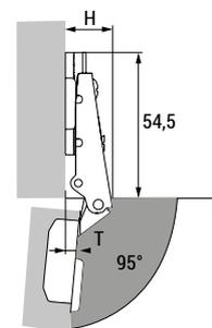
Висина на телото на шарката H/ растојание од страницата при отворање на вратата T за растојание D=1.5mm и растојание до отворот за шарката C=3mm
