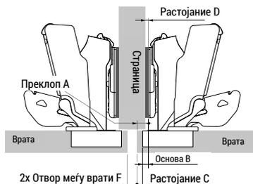
$$\text{Растојание D} = \text{C} + \text{B} - \text{A}$$
