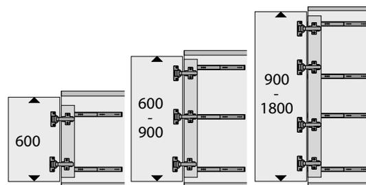
Бројот на потребни водилки од KA5740 зависи од висината на елементот.
